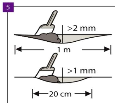
Stellen Sie sicher, dass der Untergrund eben ist. Eine Unebenheit von mehr als 1 mm über eine Länge von 20 cm muss ausgeglichen werden. Das Gleiche gilt für Unebenheiten von mehr als 2 mm über einer Länge von 1 m. Verwenden Sie eine geeignete Ausgleichsmasse und prüfen Sie, ob eine Grundierung oder ein Dichtmittel erforderlich sind. Um den Untergrund sorgfältig vorzubereiten ist die ganze Oberfläche mit selbstverlaufenden Ausgleichsmassen zu nivellieren.
