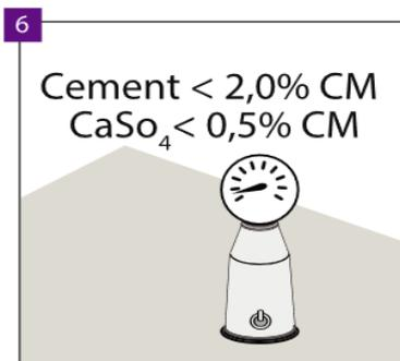
Beim Zementausgleich darf die Feuchtigkeit des Unterbodens 2,0% nicht überschreiten, und bei Anhydritmassen 0,5%. Bei der Verlegung über der Bodenheizung betragen die erforderlichen Werte jeweils 1,8% und 0,3%
