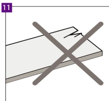
Vor und während der Verlegung sind eingehend auf Beschädigungen und Materialfehler zu überprüfen. Paneele mit sichtbaren Mängeln oder Beschädigungen dürfen nicht verlegt werden.
