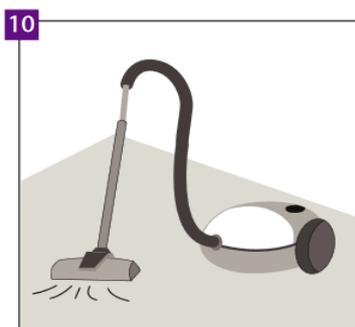
Stellen Sie sicher, dass der Untergrund trocken, flach, stabil und frei von Fett sowie chemischen Substanzen ist. Vor der Verlegung ist der Untergrund zu fegen und zu staubsaugen. Größere Beschädigungen und Risse sollen beseitigt werden.
