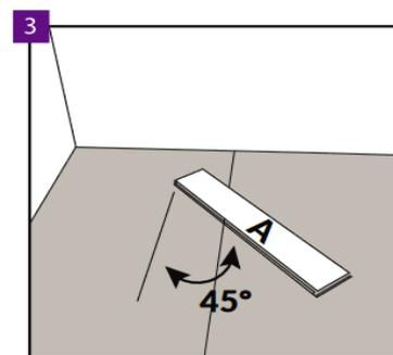
Beginnen Sie die Verlegung von links nach rechts mit Paneel A, das um 45° zu drehen ist. Die Seiten der Paneele an der Wand sollten in einem Winkel von 45° proportional zu den Wänden geschnitten werden. **ACHTUNG!** Lassen Sie erforderliche Dehnungsfugen an den Wänden (siehe Verlegung, Abbildung 15).
