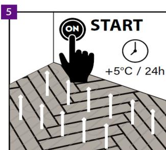
Nach der Verlegung und dem Ablauf von 24 Stunden kann die Fussbodenheizung eingeschaltet werden. Es ist zu beachten, dass die Temperatur langsam erhöht wird (5°C pro Tag).
