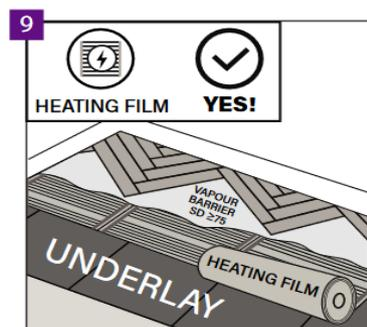
Die Verlegung auf einer Heizfolie ist ebenfalls zulässig, sofern eine dafür geeignete Unterlage und eine zusätzliche Dampfbremsfolie mit SD  $\geq 75$  verwendet werden. Das gesamte System besteht aus einer direkt auf den Untergrund verlegten Dampfbremsfolie, dann einer entsprechenden Unterlage (mind. 400 kPa, die empfohlene Dicke der Unterlage beträgt 5 mm), darüber einer Heizfolie, einer Dampfsperrfolie und dem Boden.
