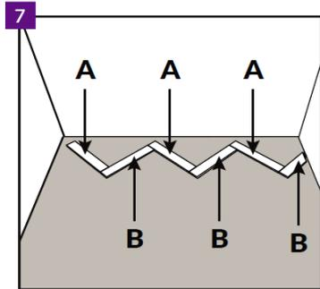
Die erste Reihe sollte aus abwechselnd verlegten Paneelen bestehen, die in der gleichen Weise verlegt werden, wie in der Abbildung gezeigt ist.
