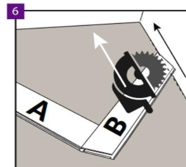
Verlegen Sie das nächste Paneel B auch in dieser Reihe (siehe Anleitung zur Bodenverlegung - Abbildung 4). Schneiden Sie das Paneel ab und achten Sie darauf, dass die Dehnungsfugen an den Wänden dabei richtig sind (siehe Anleitung zur Bodenverlegung - Abbildung 15).
