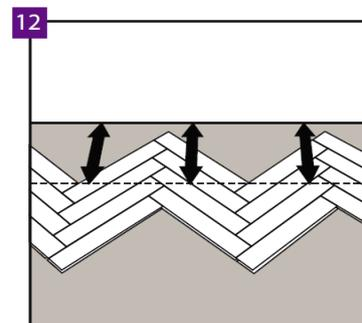
Nachdem Sie vier Reihen vollständig verlegt haben, legen Sie die Linie fest, nach der der Boden geschnitten wird, so dass das entstandene Fragment zur Wand hin verschoben werden könnte.
