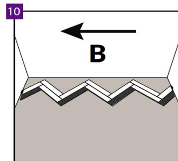
Es ist wichtig, dass jede Reihe nach dem Prinzip der Verlegung der Paneele B auf der linken Seite installiert wird, d.h. in der entgegengesetzten Richtung zur Verlegung der Paneele A.
