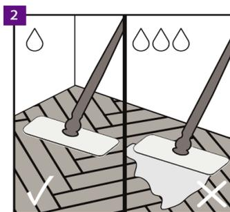
Der Boden kann mit einem feuchten Mopp gereinigt werden.
