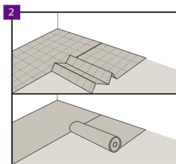
Stellen Sie sicher, dass der Untergrund richtig vorbereitet ist. Verlegen Sie dann eine Dämmunterlage von Arbiton oder Ewifoam, die für Rigid- und LVT-Böden geeignet ist. Benachbarte Bahnen der Dämmunterlage müssen dicht aneinander passen und überlappend oder mit Arbiton- oder Ewifoam-AluTape miteinander fixiert werden, ohne Fugen dazwischen zu lassen.
