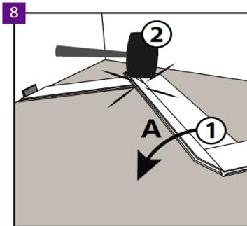
Die Verlegung der zweiten Reihe sollte man auch mit Paneel A beginnen. Bitte beachten Sie immer die Verlegevorschriften - bei der Verlegung von Paneel B auf Paneel A werden die Längsseiten durch Befestigung und die Stirnseiten durch Einklopfen montiert.
