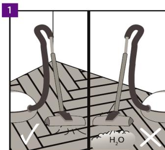
Der Designboden von Arbiton kann gestaubsaugt werden. Verwendung von Dampfreinigungsgeräten ist verboten.
