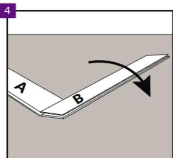
Verlegen (befestigen) Sie Paneel B ohne Hammer in der Richtung, wie in der Abbildung oben gezeigt ist.
