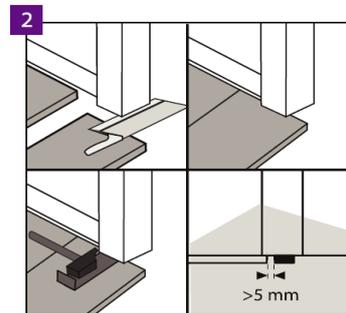
Dilatationen entlang den Wänden sollen mit passenden anhand von Klebstoff oder Klips montierten Sockelleisten zugedeckt werden. Wir empfehlen unsere Sockelleisten von Arbiton, die zu einzelnen Designbodendekoren passen und stoß- und kratzbeständig sind.
