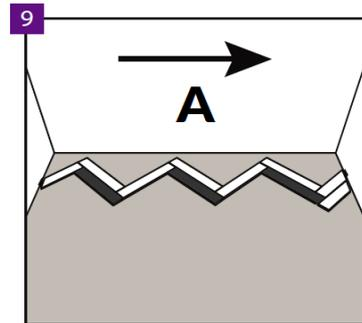
Es ist sehr wichtig, dass jede Reihe nach dem Prinzip der Verlegung der Paneele A in der richtigen Richtung installiert wird.
