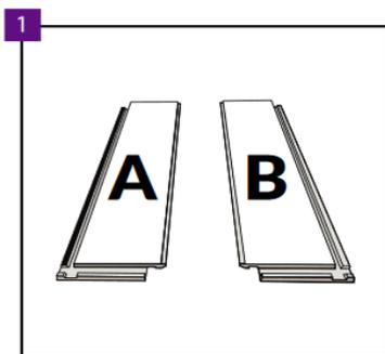
Jedes Paket enthält zwei Arten von Paneelen: A und B. Die Paneele sind zur leichteren Unterscheidung unten mit A oder B gekennzeichnet. Die Teile A und B müssen vor der Verlegung sortiert werden. Bei der Verlegung ist es sehr wichtig, darauf zu achten, dass die Paneele A und B an den richtigen Stellen in der Reihe verlegt werden (siehe -> Bodenverlegung, Punkte 7; 9 und 10).
