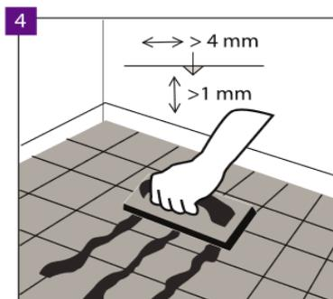
Bei der Verlegung auf keramischen Fliesen soll die Fugenbreite nicht mehr als 4 mm und die Tiefe nicht mehr als 1 mm betragen. Größere Abstände sind mit Harzmasse auszufüllen. Der Boden kann auf Fliesen mit Fugen mit einer Breite von bis zu 5 mm und einer Tiefe von 1 mm ohne deren Ausgleich verlegt werden, unter der Voraussetzung, dass die Unterlage Multiprotect Super Hardlay oder Vinclic Super Solid verwendet wird.
