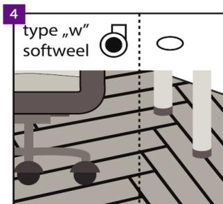
Es wird empfohlen Stühle mit Rollen vom Typ W zu nutzen und den Designboden zusätzlich mit einer Schutzmatte vor enormer Abnutzung zu sichern. Möbelbeine sollen mit Schutzuntersetzer (z.B. Filz-) versorgt werden.
