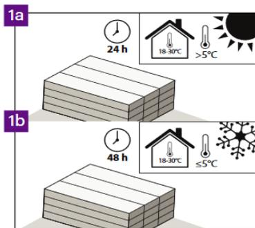
Wenn die Temperatur während des Transports  $>5^{\circ}\text{C}$  beträgt, sollte die Akklimatisierungszeit in einem Raum mit einer Temperatur von  $18-30^{\circ}\text{C}$  min. 24 Stunden. Bei einer Temperatur von  $\leq 5^{\circ}\text{C}$  während des Transports sollte die Akklimatisierungszeit in einem Raum mit einer Temperatur von  $18-30^{\circ}\text{C}$  jedoch mindestens 2 Stunden betragen 48 Stunden.
