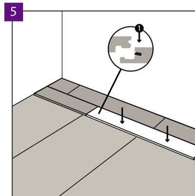
Senken Sie danach das Paneel so ab, um die kurze Kante verriegeln zu können, klopfen Sie vorsichtig das Paneel ein. Beginnen Sie in der Ecke des Raumes. Der Verschluss auf der kurzen Kante ist mit einer speziellen Verriegelung versehen, die bei der richtigen Verlegung eingeschlossen wird. Beim Verlegen darf kein Druck ausgeübt werden! Wenn Schwierigkeiten bei der Paneeleabsenkung bzw. Verriegelung entstehen, ist der Abstand im Verschluss zu vergrößern und das Paneel noch einmal abzusenken.
