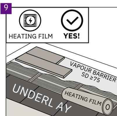
Die Verlegung auf einer Heizfolie ist ebenfalls zulässig, sofern eine dafür geeignete Unterlage und eine zusätzliche Dampfbremssfolie mit SD ≥75 verwendet werden. Das gesamte System besteht aus einer direkt auf den Untergrund verlegten Dampfbremssfolie, dann einer entsprechenden Unterlage (mind. 400 kPa, die empfohlene Dicke der Unterlage beträgt 5 mm), darüber einer Heizfolie, einer Dampfsperffolie und dem Boden.
