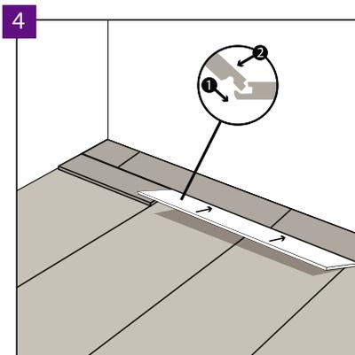
Die Arbiton-Bodenpaneele werden mit den Verschlüssen, die auf der kurzen und der langen Kante zu verbinden sind, versehen. Zuerst müssen die langen Kanten der Paneele miteinander verbunden werden. Dafür ist die lange Paneelekante in die früher verlegte Paneelereihe einzuschieben. Verschieben Sie das Paneel bis zum Winkel, lassen Sie einen kleinen Abstand.
